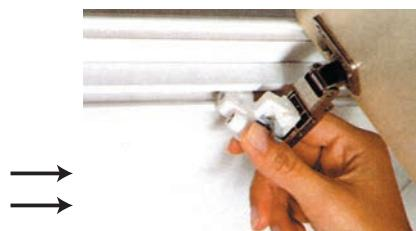
スライディングブロックのローラー部を90度廻してレールにセットします。
