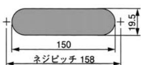
取付穴参考寸法 埋め込みタイプ
